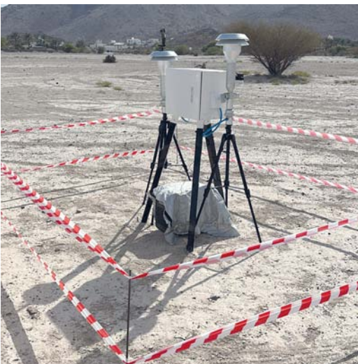
تركيب أجهزة رصد متخصصة للملوثات الهوائية الجوي وجمع العينات الميدانية
