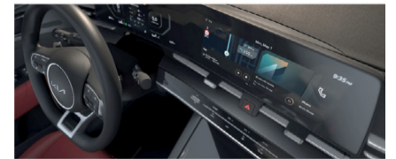
شاشة منحنية مدمجة مقاس ١٢.٣ بوصة (مجموعة العدادات) + شاشة عرض للوسائط المتعددة تي إف تي وإل سي دي مقاس ١٢.٣ بوصة (نظام المعلومات والترفيه)
